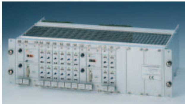
Bild 4: Innenanlage des Achszählsystems ACS2000 - 19"-Baugruppenträger zur Überwachung von zwei Achszählabschnitten (einer mit sechs und einer mit zwei Zählpunkten)
