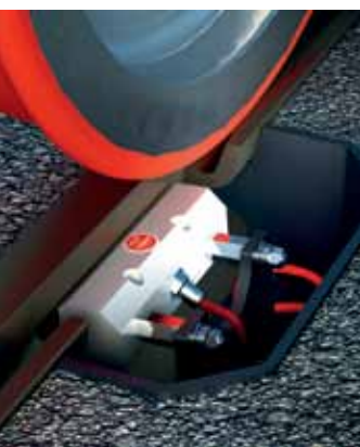
Zwarta budowa i prosta regulacja czujnika koła dzięki jarzmu do szyny rowkowej firmy Frauscher
